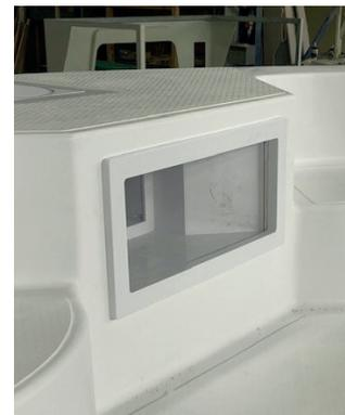
2. Appliquez les joints noirs des deux côtés de l'ouverture afin que les ouvertures de vis soient bien centrées sur les passages de vis.
